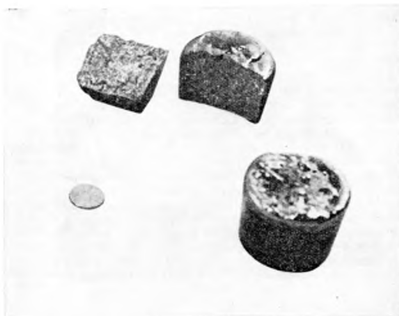
13-8. ábra. Szakaszos öntési-eljárással a VKI-ban készült GeSi öntecsek
