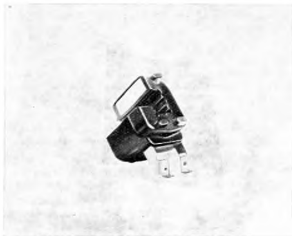
3-5. ábra. Bandázsolás és csévetest nélküli tokozott tekercs
